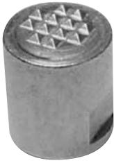
杰根斯公司的可替换齿面支承头所用材料有淬火硬化高速工具钢或硬质合金钢嵌入。由于支承头齿面的齿尖被压入工件，所以能以更小的压紧力产生更大的夹持力。杰根斯的齿面支承头的固定方式有两种：支承头本身作为螺钉旋入螺孔固定，或依靠支承头背后的螺纹孔固定。
